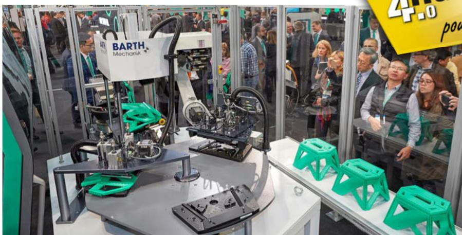
El nuevo ejemplo de Industria 4.0 ilustra la producción en tamaño de lote 1 de tirantes de diferentes longitudes sobremoldeados con distintas piezas terminales (foto sup.). La instalación "llave en mano" alrededor de la ALLROUNDER 1120 H produce los taburetes plegables ARBURG terminados (foto izda.).
