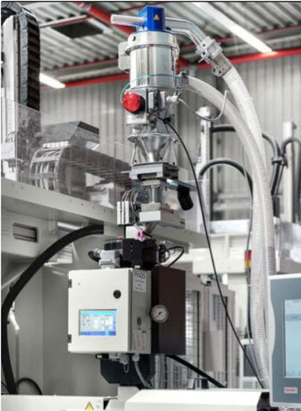
En el proceso físico para la inyección de espuma ProFoam el material plástico se enriquece con agente propulsor en una esclusa de granulado ya antes de la unidad de inyección.
