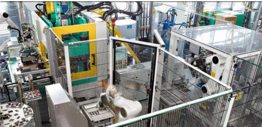
Stephan Schöne, Projektplanung bei H&B Electronic (Bild links), setzt bei der Fertigung von icam-Steckern (Bild oben) auf eine Zwei-Komponenten-Drehtischmaschine. Die Bauteile für BMW-Einparkhilfen werden vollautomatisch produziert (Bild rechts).
