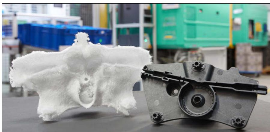
ROS-Geschäftsführer Steffen Tetzlaff (Bild links) fertigt im FDC-Verfahren faserverstärkte Seilantriebsgehäuse mit eigenem 4-fach-Werkzeug (Bild unten). Die Glasfasern werden über eine Seitenbeschickung (Bild oben) zugeführt und geschnitten. Die homogene Verteilung der Glasfasern ist nach Veraschung des Bauteils zu sehen (Bild rechts).
