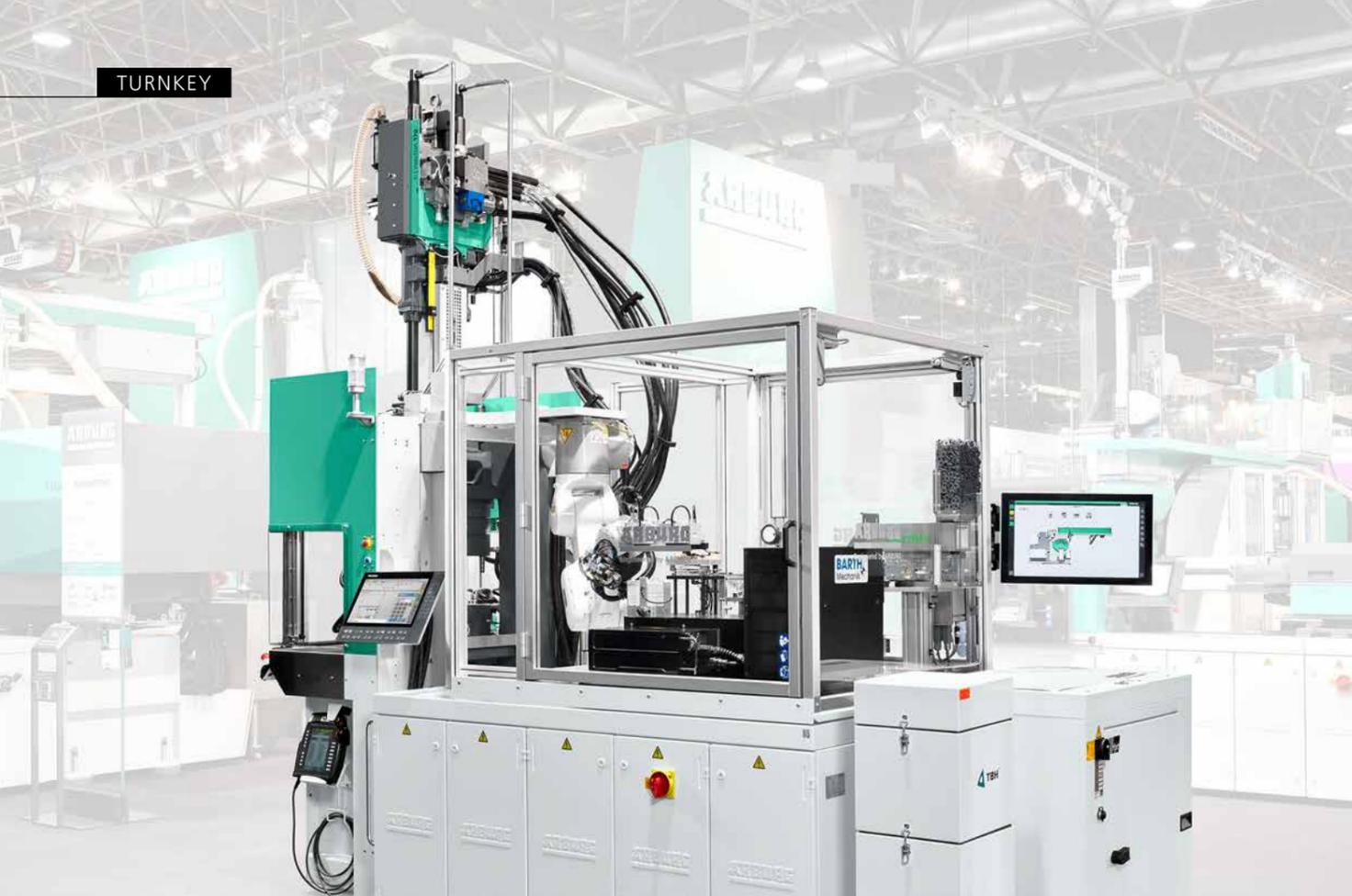
Una cella di produzione con ALLROUNDER verticale, robot a sei assi e ATCM (foto a sinistra) produce in modo completamente automatico un attrezzo per biciclette (foto in basso).
