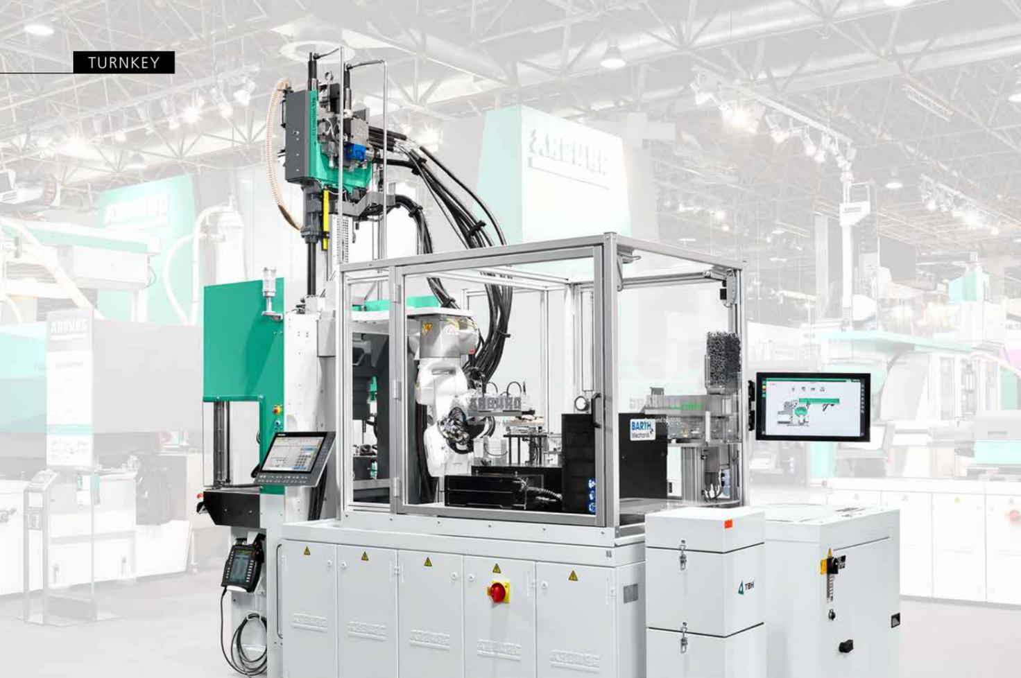
Eine Fertigungszelle mit vertikalem ALLROUNDER, Sechs-Achs-Roboter und ATCM (Bild links) fertigt vollautomatisch ein Fahrrad-Werkzeug (Bild unten).
