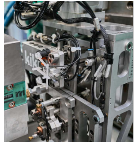
在这套交钥匙系统（左图）上，夹钳首先将磁铁插入到模具中，接着取出注塑件和浇口（上图）。
