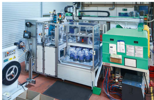
Con l'impianto compatto «chiavi in mano» Goerlich realizza scatole per sensori di pressione negativa in modo efficiente e flessibile.
