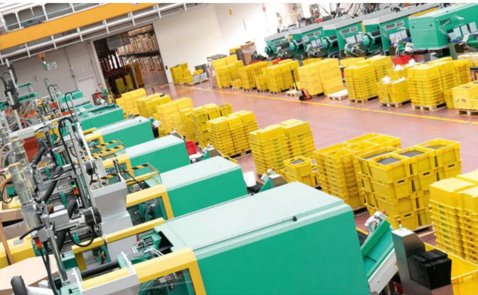
ALLROUNDER 420 C advance, das Außenteil mit Gewinde aus PPO G30 ein ALLROUNDER 520 C advance. Beide arbeiten mit Zwei-Kavitäten-Werkzeugen mit Heißkanalsystem und Nadelverschlussdüsen zum angusslosen Einspritzen.
