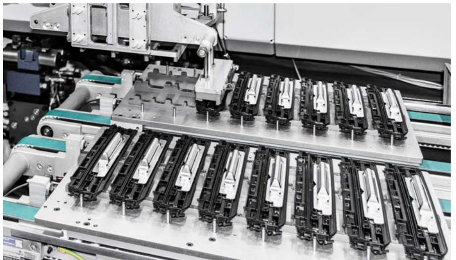
硬膠/軟膠結合成品部件取出，並將其放置在一個配備 48 個位置的冷卻站。
