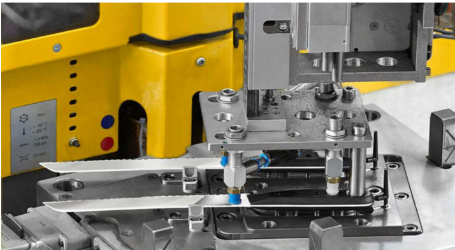
L'operatrice di produzione Kerstin Beyer (foto in alto) mostra il coltello con il manico stampato a iniezione (in alto) e il prodotto finito rivettato (in basso). Dopo lo stampaggio a iniezione una pinza pneumatica rimuove le materozze (foto in basso).
