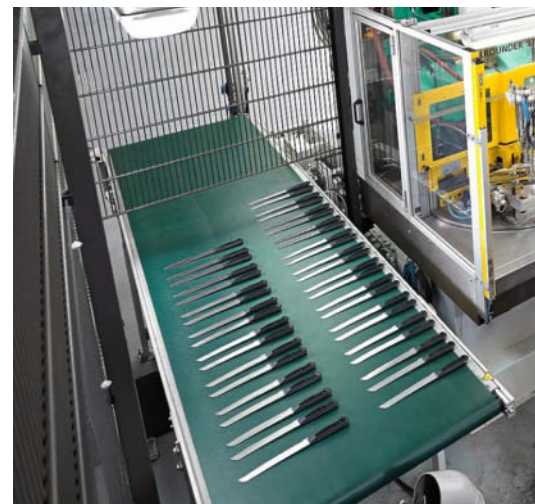
Die flexible Fertigungszelle kann rund 35 verschiedene Klingensformen mit drei unterschiedlichen Griffgrößen umspritzen.
