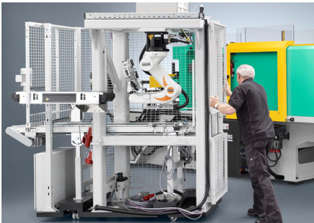
Trasferimento agevolato: Il modulo compatto può essere facilmente trasferito (1). Idee innovative: Con diversi robot mobili è possibile creare anche unità di produzione completamente nuove (cfr. a destra).
