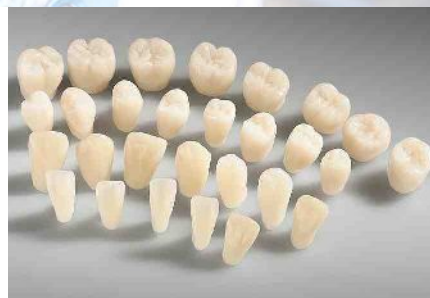
144 diversi denti in PMMA per protesi: Prodotti in circa 30 secondi. Otto pezzi, una ALLROUNDER 520 A.
