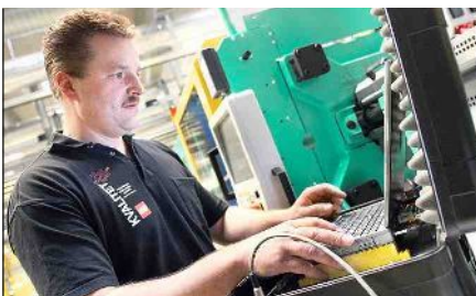
Bei LEGO wird nichts dem Zufall überlassen: Finn Stenager Juhl ermittelt den Energieverbrauch der Spritzgießmaschinen unter Praxisbedingungen.
