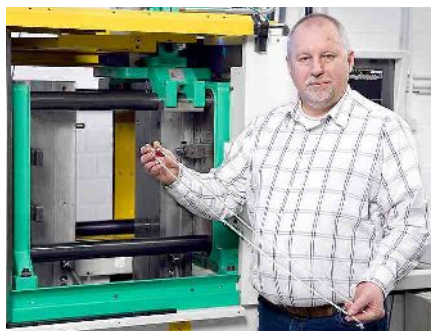
Fertigungsleiter Christian Broich (links unten) zeigt den Lichtleiter, der auf einem ALLROUNDER 420 C in einem Ein-Meter-Werkzeug (unten) vertikal eingespritzt wird.
