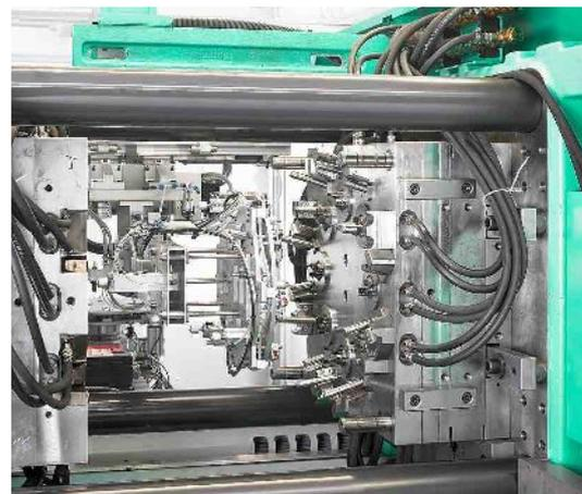
guaine in un'unica fase di lavoro. Successivamente la pinza del sistema robot nello stampo aperto, sul lato iniezione, esegue lo scarico e dispone gli inserti in materiale termoplastico in Vyncolit X613 esattamente nelle cavità e, ancora una volta, in un'unica fase di lavoro.
