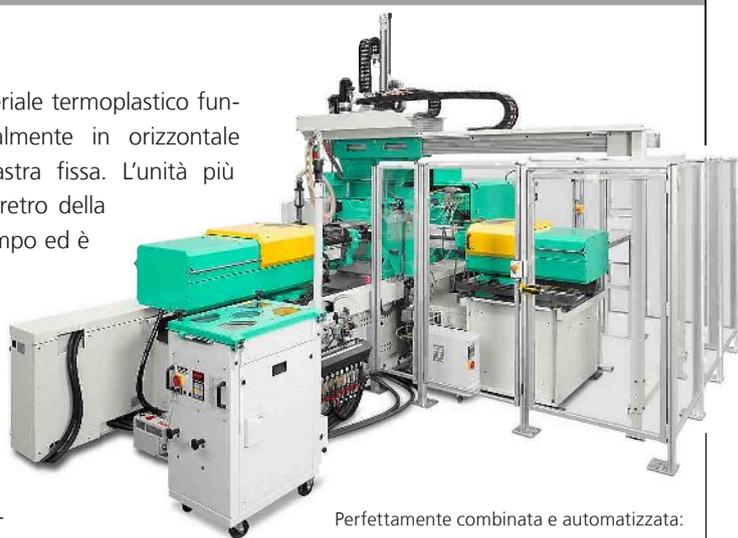
Perfettamente combinata e automatizzata: La produzione di un tubo di raffreddamento dell'acqua con elementi di tenuta in elastomero nel processo di stampaggio ad iniezione bicomponente.
