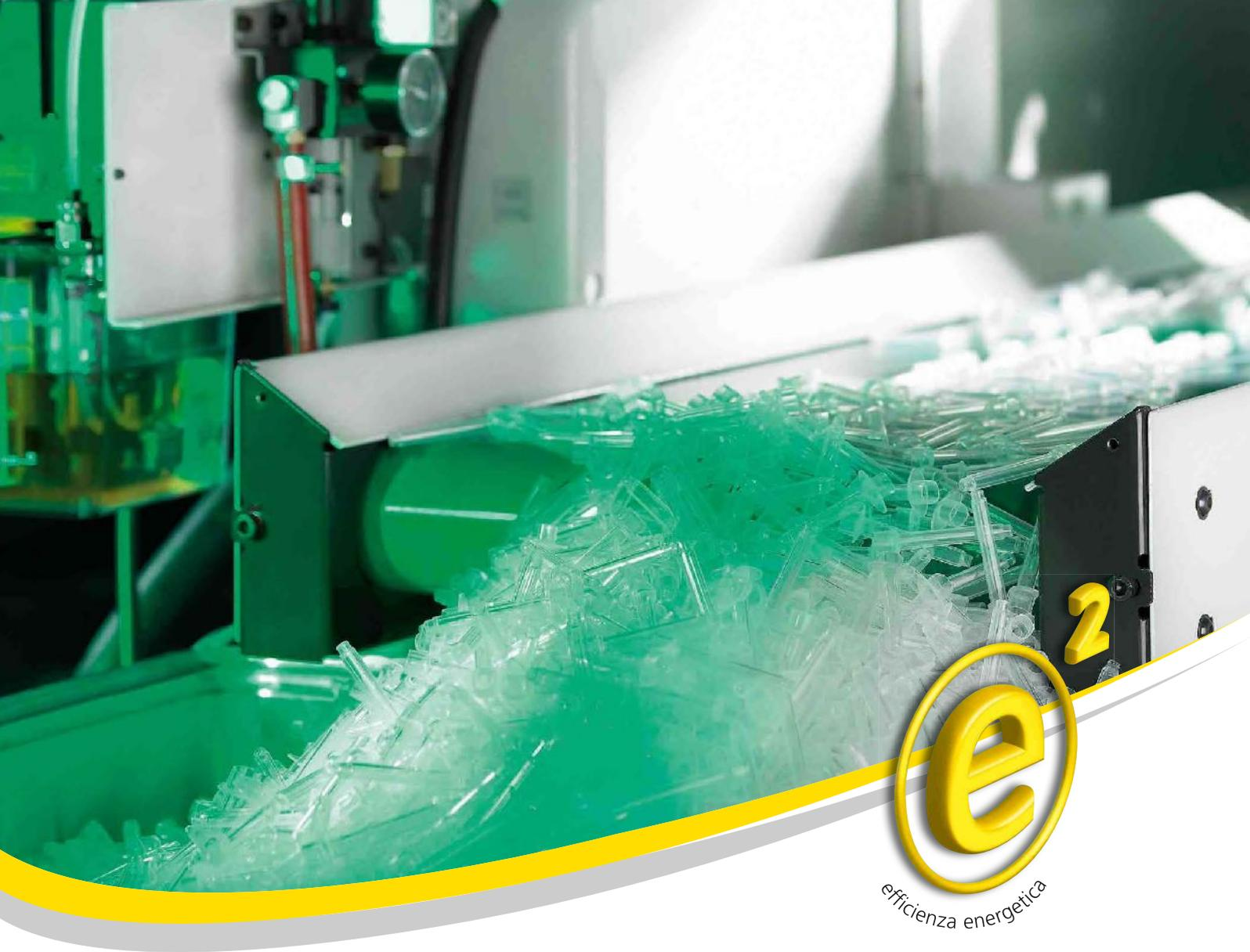
**Elettricamente innovativa.** Riproducibilità, precisione, velocità ed anche ad efficienza energetica: ARBURG con le sue ALLROUNDER A totalmente elettriche, ha trovato la soluzione giusta per soddisfare le esigenze dei suoi clienti. Le ALLDRIVE totalmente elettriche offrono una gamma di forze di chiusura da 350 a 3.200 kN. Efficienza e precisione per un utilizzo versatile.
