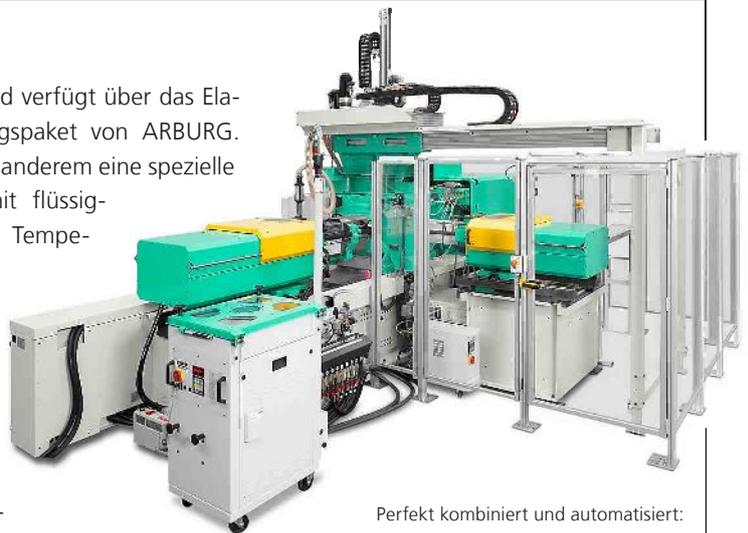
Perfekt kombiniert und automatisiert: Die Herstellung eines Kühlwasserrohrs mit integrierten Elastomer-Dichtelelementen im Zwei-Komponenten-Spritzgießverfahren.
