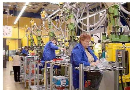
non vengono usati solo stampi modulari, i cui inserti sono facilmente e rapidamente cambiabili, ma attualmente la società ha sviluppato anche un proprio sistema di cambio rapido. A rendere flessibile la produzione contribuisce inoltre la capacità di allestimento delle macchine speciali, che in questo modo possono essere utilizzate per diversi prodotti.
