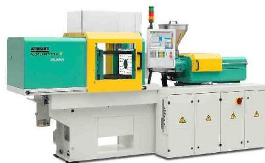
pa a potenza minima e un motorino della categoria di rendimento EFF1. La regolazione del carico dinamica dell'accumulatore idraulico adatta il livello di pressione automaticamente al fabbisogno effettivo e garantisce in questo modo un funzionamento a efficienza energetica. Complessivamente i risparmi energetici realizzabili si aggirano intorno al 40%.
