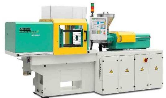
miento del acumulador hidráulico trabaja con una potencia instalada mínima de la bomba y cuenta con un motor de la clase de eficiencia EFF1. Además de lo expuesto, la regulación dinámica de la carga del acumulador hidráulico adapta automáticamente el nivel de presión a las demandas actuales y vela así por un funcionamiento optimizado en energía. En total pueden conseguirse ahorros energéticos de hasta un 40 por ciento.
