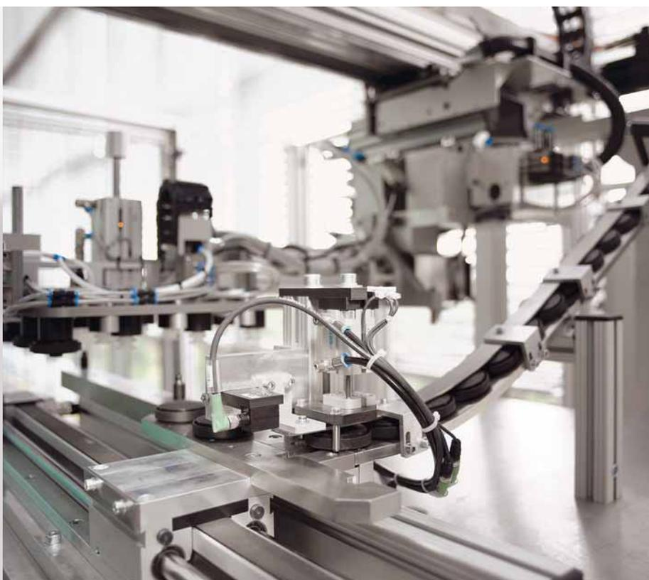
Die Fertigungszelle sollte in der Lage sein, Möbelrollen mit 50, 60, 65 und 70 Millimetern Durchmesser herzustellen. Daher mussten Robot-System und Peripherie so ausgelegt oder konzipiert werden, dass ein Umrüsten schnell und einfach realisiert werden kann.
