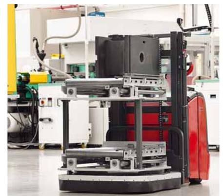
te auf der Rollenbahn seitlich auszurichten und zu fixieren. Ein Herunterrollen der Werkzeuge während des Transports wird durch eine stirnseitige Verriegelung verhindert.
