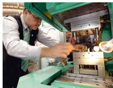
Beim ALLROUNDER V kann die Bestückung mit dem Einlegeteil und die Entnahme des fertigen Spritzteils auch manuell erfolgen.
