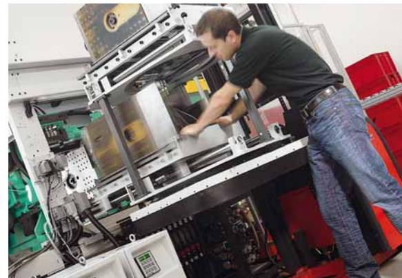
erfordert generell eine Standardisierung der Aufspannplatten. Gegenüber einem herkömmlichen Werkzeugwechsel lassen sich Rüstzeiten und damit Maschinenstillstandszeiten jedoch deutlich verkürzen.
