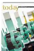
ALLROUNDER in fila sui banchi di prova. Le presse vengono spedite ai Clienti solo dopo approfonditi test e prove a carico al banco.
