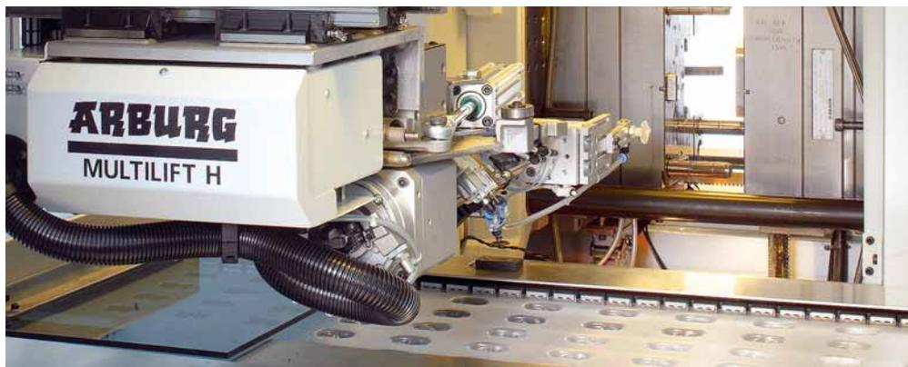
ni che ARBURG offre ai suoi Clienti secondo il profilo delle loro esigenze: lo spettro spazia dalle presse, che sono completamente in ambiente incontaminato, agli ambienti incontaminati decentrati e modulari, nei quali il nastro trasportatore è incapsulato ed i pezzi stampati vengono trasportati nell'ambiente incontaminato, fino ad arrivare ad isole con moduli adeguati per questo ambiente, sistemati sopra il lato chiusura della pressa e del settore dove si trova il sistema robot.
