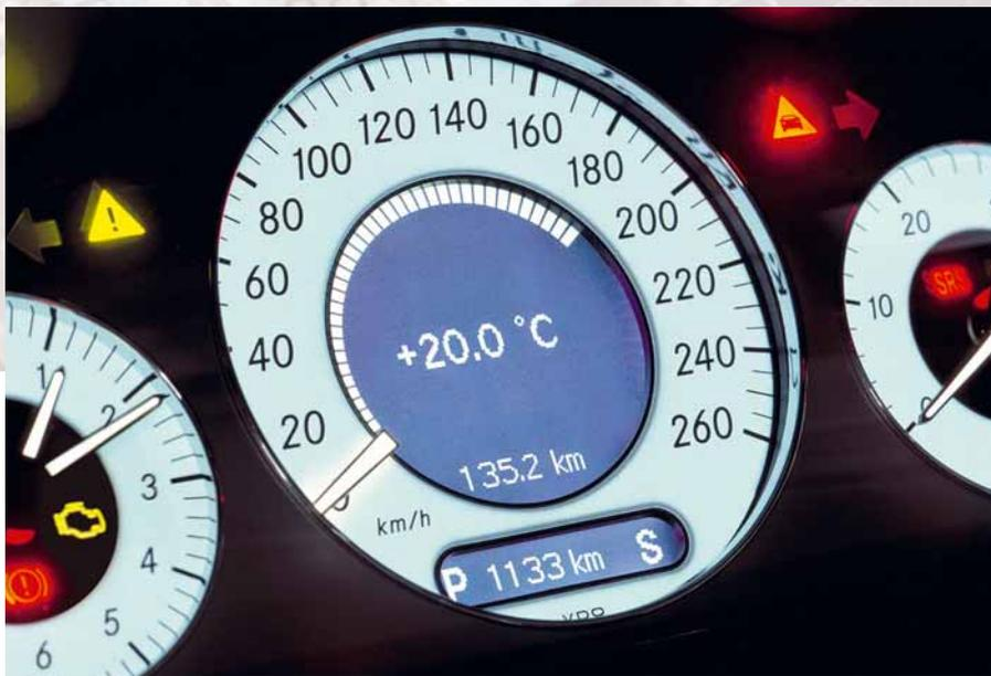
**A**ffinchè gli strumenti rotondi e tutti gli altri indicatori analogici, installati su autocarri ed autovetture, siano in grado di dare informazioni esatte ai conducenti, vengono inseriti a monte i così detti motori passo-passo che, attraverso ruote dentate ed a vite, trasformano tutte le informazioni rilevate in movimenti delle lancette, i più esatti possibile. In Siemens VDO Automotive, a Babenhausen (Assia) le scatole dei motori passo-passo si producono sulle isole di produzione ALLROUNDER.
