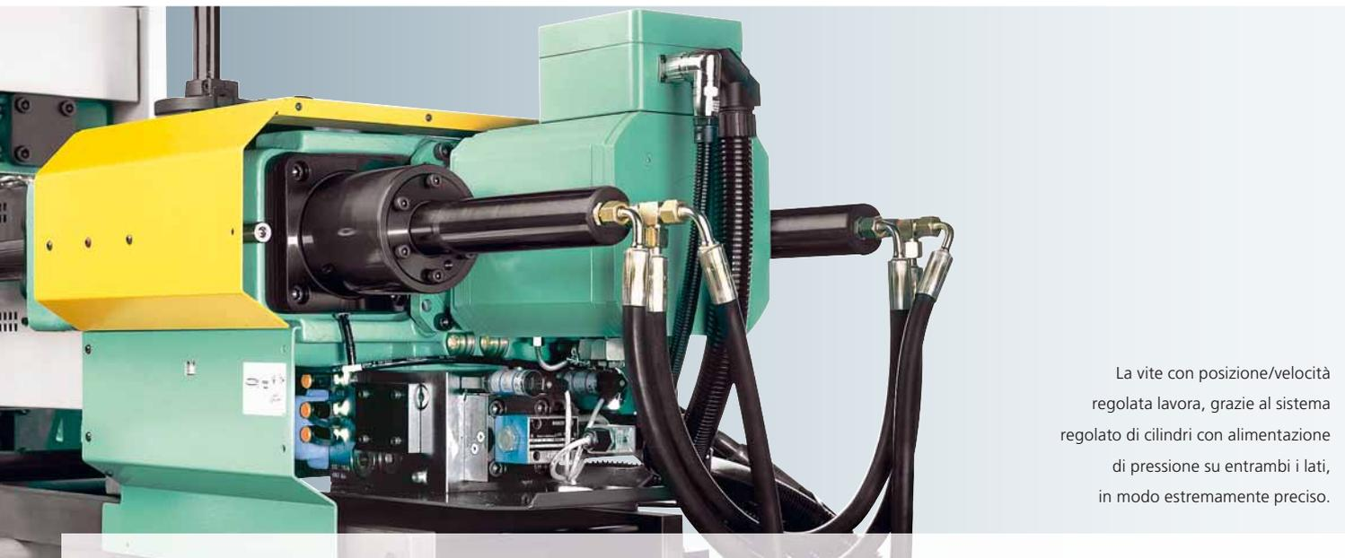
La vite con posizione/velocità regolata lavora, grazie al sistema regolato di cilindri con alimentazione di pressione su entrambi i lati, in modo estremamente preciso.
