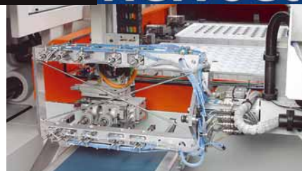
Le robot extrait du moule les pièces injectées bi-composant et les dépose dans des barquettes en plastique.
