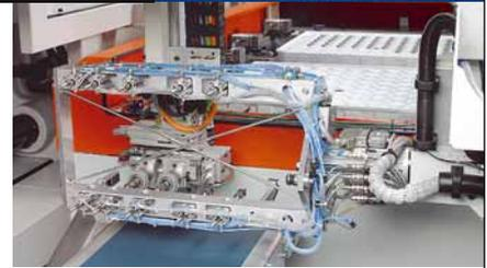
Durch das Robot-System werden die Zwei-Komponenten-Spritzteile aus dem Werkzeug entnommen und in Kunststoff-Trays palettiert.
