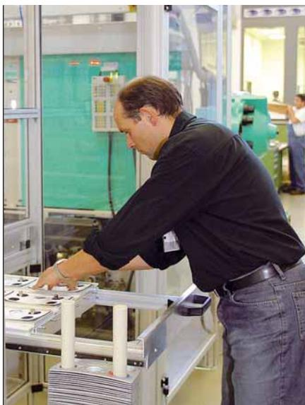
Das leuchtende Formteil (oben) entsteht durch Hinterspritzen spezieller Folien, die manuell in Schubladen eingelegt werden (unten).
