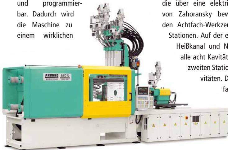
Fünf-Komponenten ALLROUNDER. Sämtliche Maschinenabläufe sind über Referenzpunkte synchronisiert und damit vollständig in die SELOGICA Steuerung integriert. Damit existiert auch nur ein gemeinsamer Datensatz, der sämtliche Informationen enthält. Fünf Schnittstellen für Einfärbegeräte erlauben die automatische Zumischung der notwendigen Farben.
