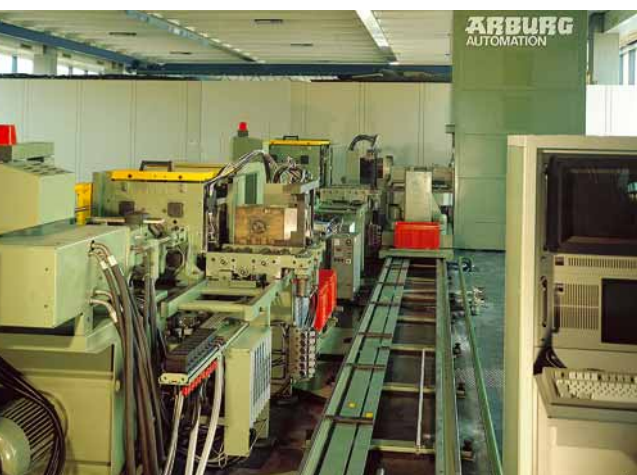
ARBURG Automation, à l'époque CMD avec plusieurs ALLROUNDER, contrôlées par ordinateur de gestion, sur une chaîne entièrement automatisée.
