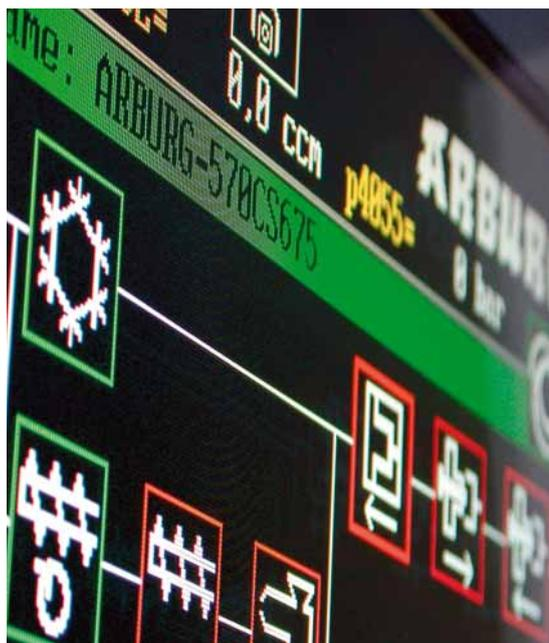
Ora ed in passato: programmazione grafica del ciclo ed intuitivamente comprensibile del gruppo di controllo SELOGICA (in alto) e commutatore decadale per il controllo dei cicli pressa su HYDRONICA (a destra).
