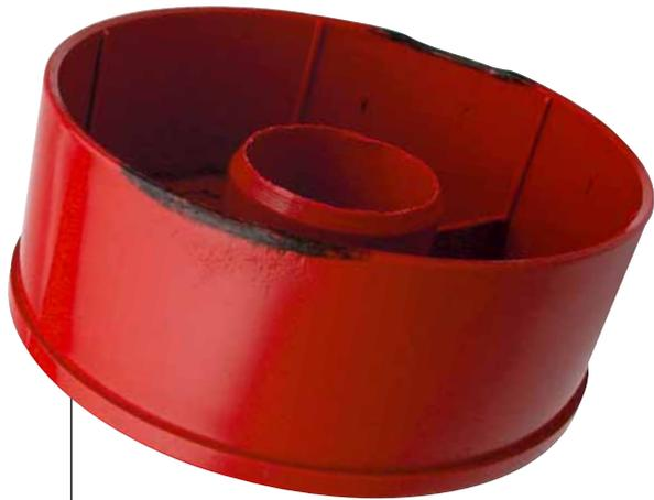
In alto. Difetti tipici dei pezzi stampati con un cattivo scarico dell'aria: „effetto diesel“ al termine dell'iniezione.
