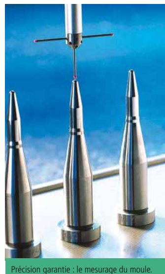
Précision garantie : le mesurage du moule.
