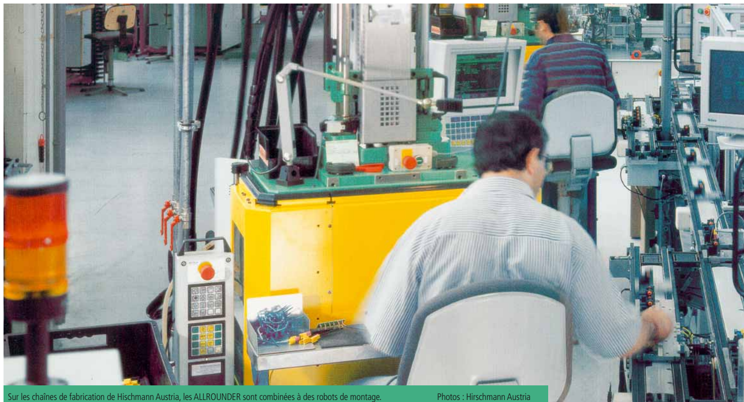
Sur les chaînes de fabrication de Hirschmann Austria, les ALLROUNDER sont combinées à des robots de montage.
