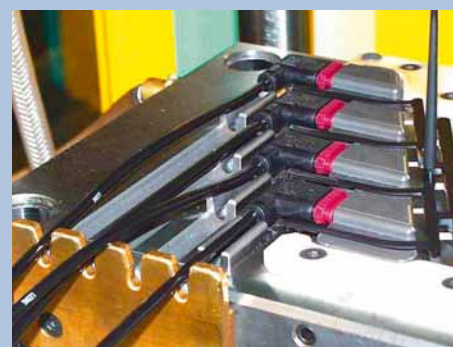
Encapsulation de fiches ABS.
