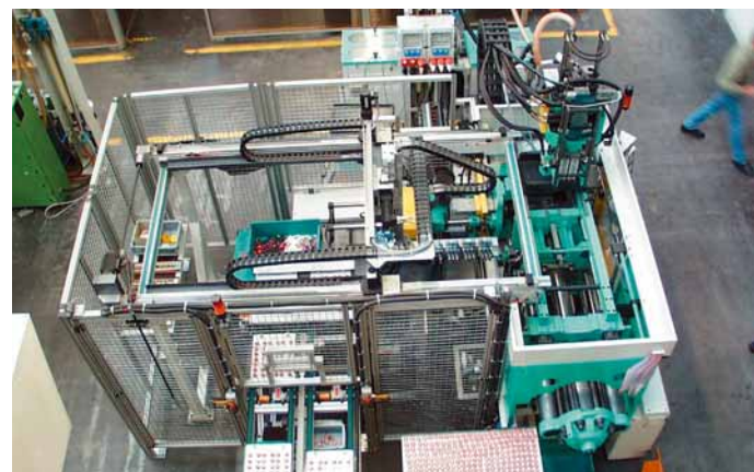
Adeguato al fabbisogno: Una ALLROUNDER 420 C per la lavorazione a tre componenti integrata in un'isola di produzione per la produzione di pistoni per cilindri.
