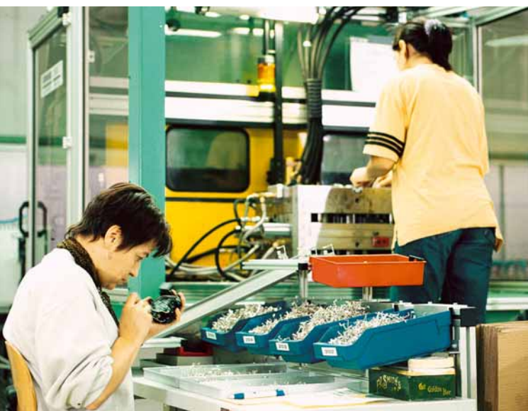
Sistemazione degli inserti di metallo nella stazione stampo della pressa a tavola rotante (a destra) e successivo controllo visivo dei pezzi stampati.
