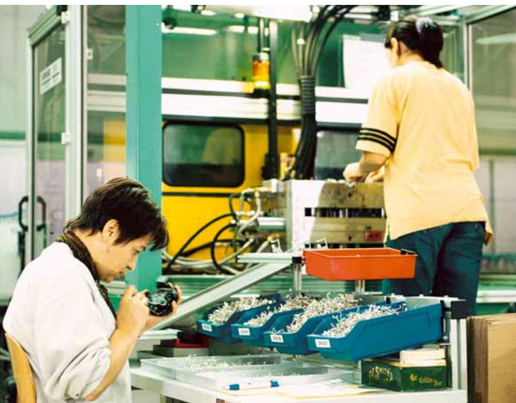
Insertion des inserts en métal dans le poste de moulage de la presse à table rotative (à droite) et ensuite contrôle visuel des pièces injectées.
