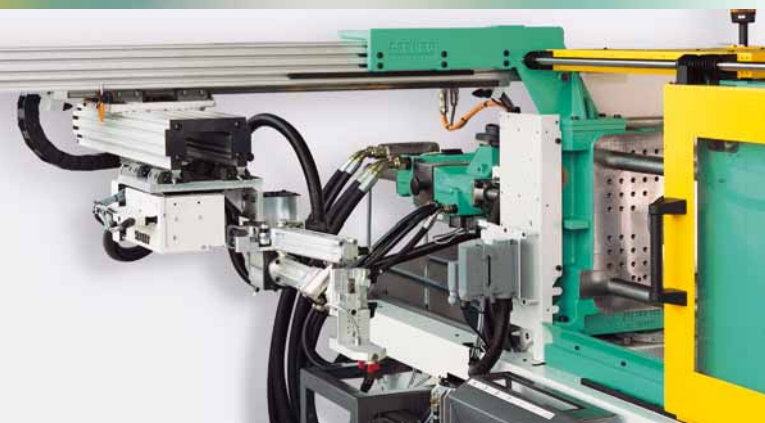
El MULTILIFT H sin dispositivo de protección – el primer paso hacia un sistema de manipulador modular.
