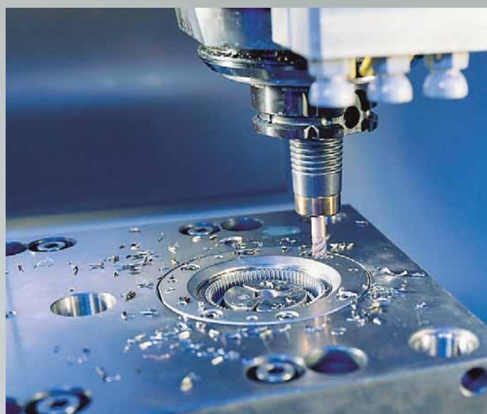
Electrodos y elaboración de un molde en la construcción de moldes propia. Fotos: Empresa Bauser.
