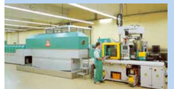
Ultramoderne : la ligne de production MIM à Rorschach. Photo : MIMtec.
