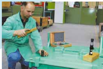
Controlli della durezza tramite il procedimento con spina di sicurezza (tranciabile) nel controllo produzione
