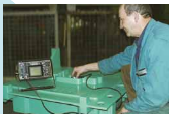
La ARBURG non lascia niente al caso: ecco un controllo ad ultrasuoni per rilevare eventuali anomalie interne
