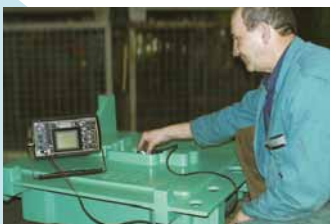
ARBURG überläßt nichts dem Zufall: Ultraschallprüfung zum Aufspüren von Innenfehlern
