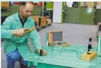
Härteprüfung per Scherstiftverfahren in der Fertigungskontrolle
