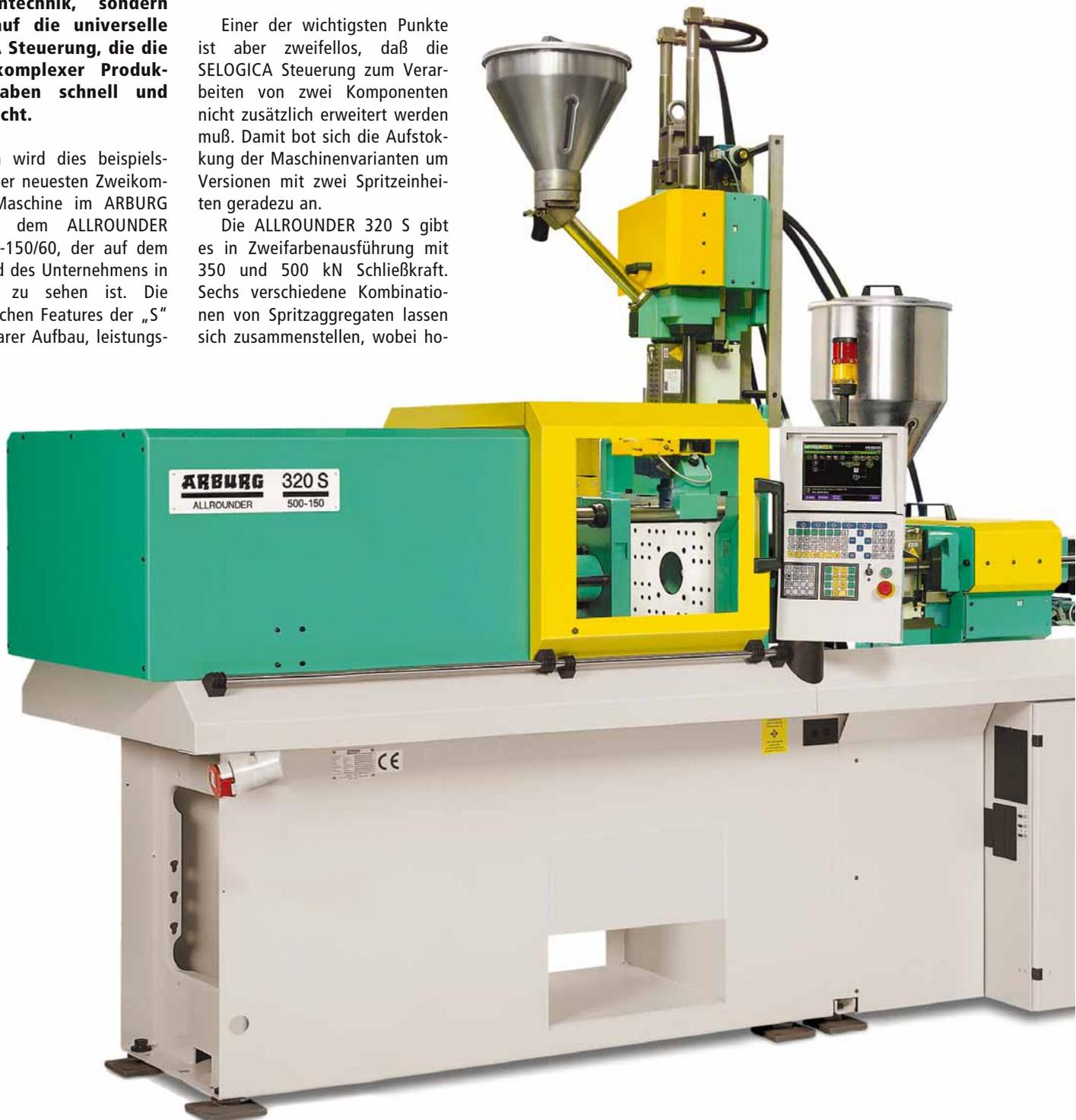
den oberen Holme der Schließbeinheit aufgesetzt und ist damit durch horizontale Verschiebbarkeit auf jede Werkzeugkonfiguration abzustimmen. Die Holmverlängerung um 100 mm macht den Einbau auch aufwendiger 2K-Werkzeuge mit umfangreicher Peripherie problemlos möglich.
