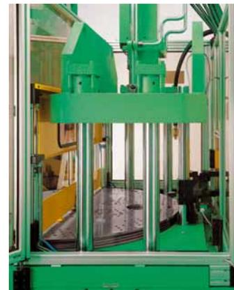
Ohne Sondersteuerung hat der Bediener über die SELOGICA auch diesen Gesamtlauf vollständig im Griff. Interessant sind besonders das eindeutige Erkennen der jeweiligen Maschinenabläufe und die direkte Zugriffsmöglichkeit auf spezielle Drehtischfunktionen. Es können hier sowohl feste als auch „mitfahrende“ Funktionen (z.B. „Ausschrauben von Station 1 auf Station 2“) programmiert und überwacht werden.
