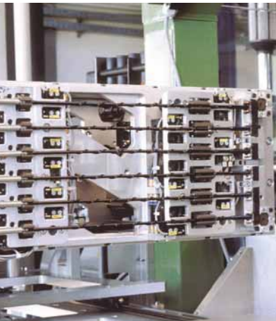
Stampo a sei cavità per il rivestimento delle antenne
