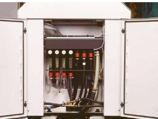
L'accumulateur à eau et le système de manipulation sont intégrés à l'intérieur de la machine
