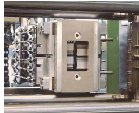
El molde de 6 figuras admite los preinyectados en la zona de boquilla. La extracción de las piezas se produce desde el semimolde móvil.
