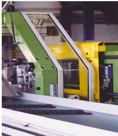
Retirada automática de las piezas inyectadas mediante banda de transporte y refrigeración.
