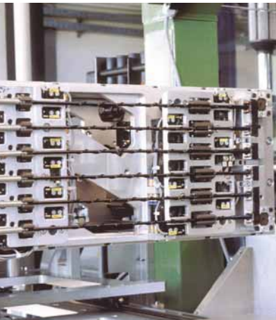
Sechsfach-Aufnahme für die Antennen-Umspritzung
