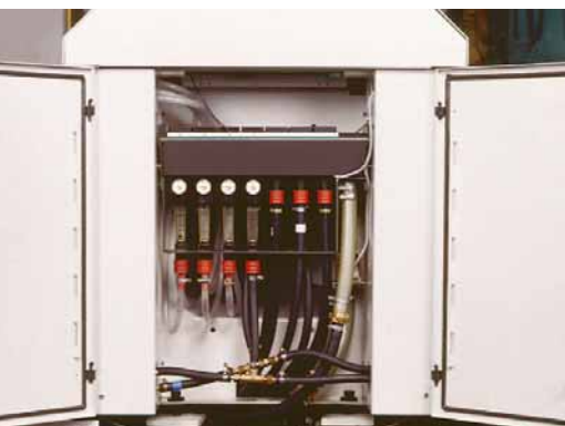
Wasserbatterie und Handling sind im Inneren des Maschinengrundrisses integriert.
