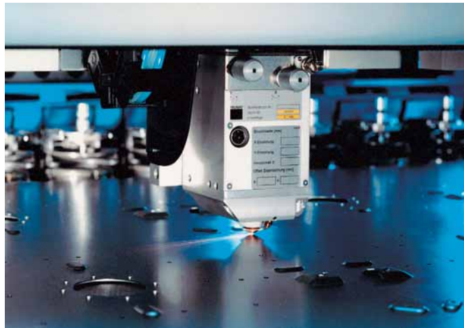
Stampaggio della lamiera e taglio al laser si combinano per garantire la massima precisione dei profili
