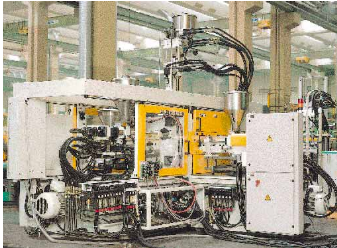
Allrounder 520 V 1300-575: la pressa ARBURG per lo stampaggio di 4 componenti
