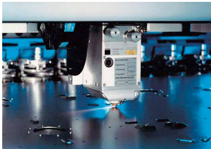
Contornos precisos mediante la combinación de la cizalladora y de la cortadora láser
