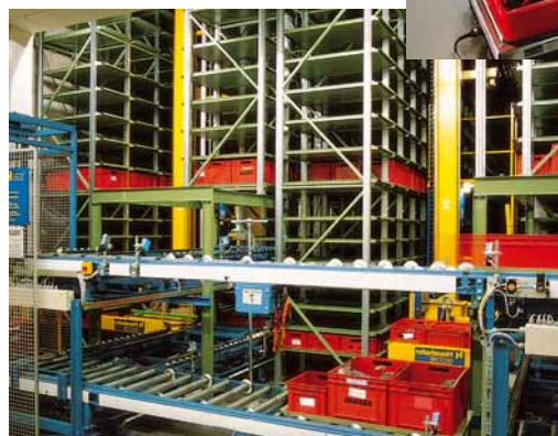
C'est entièrement piloté par ordinateur et sans intervention humaine que la pièce sort de l'entrepôt
