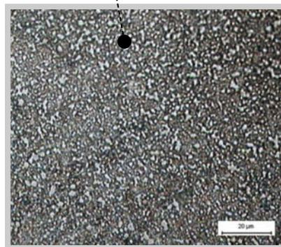
Resistente all'usura: struttura a base di carburo nell'acciaio fuso.
