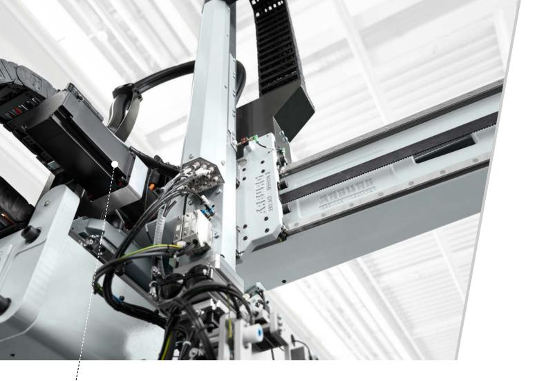
Tecnologia di azionamento avanzata: movimenti sincroni, rapidi e precisi mediante servomotori con regolatori separati
