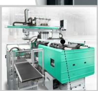
Montaggio mediante piastra portastampo mobile, ideale in caso di unità di iniezione verticale
