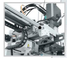
Versione MULTILIFT H 3+1 con due assi di intervento orizzontali, progettata specificamente per il microstampaggio a iniezione
