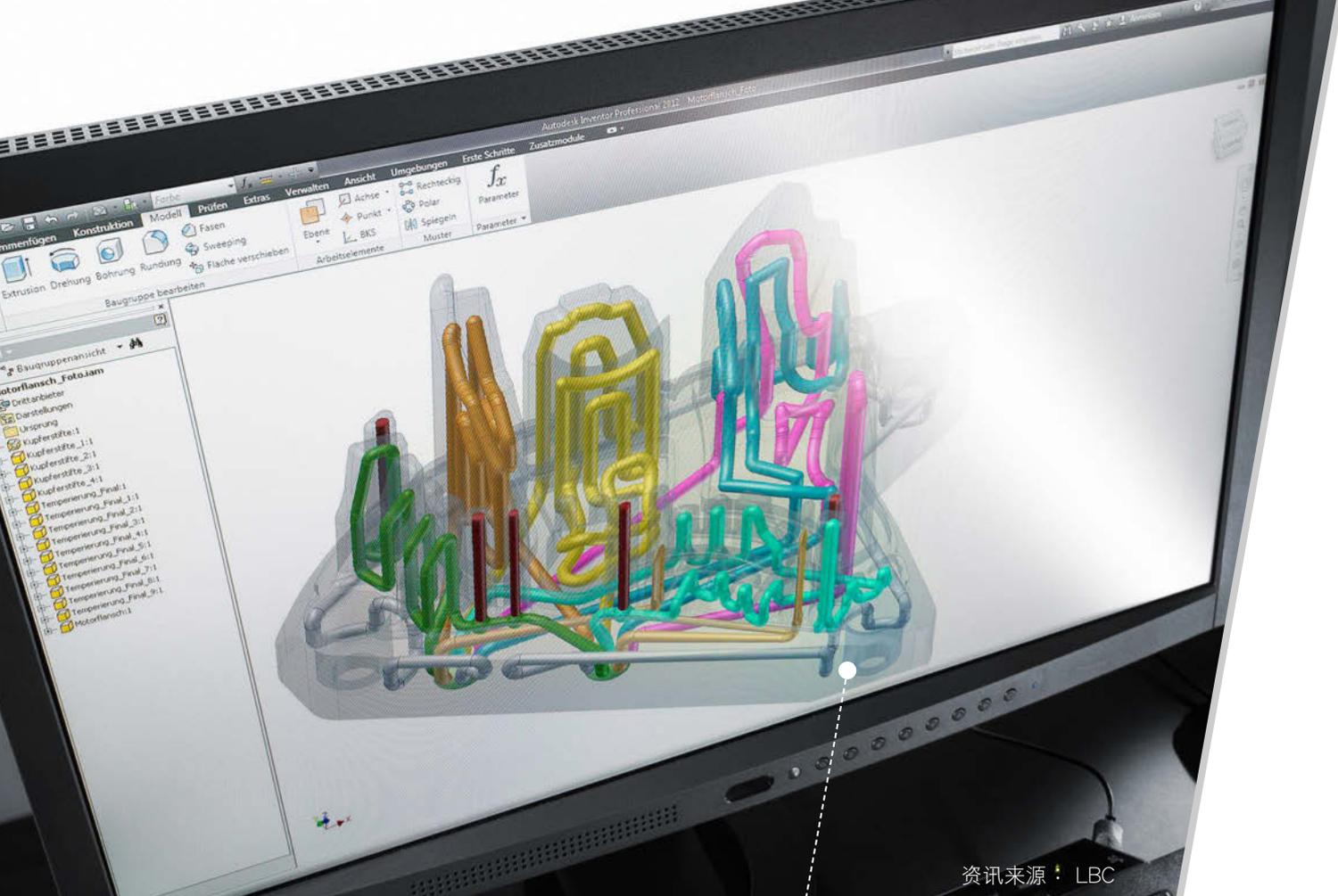
最接近模芯模具温度可缩短循环时间并确保更好地控制流程。
