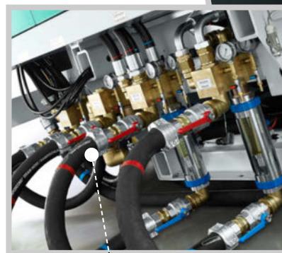
Buena refrigeración: conductos de alimentación con grandes secciones transversales.
