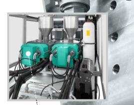
Posición L: segunda unidad de inyección en horizontal en la parte trasera de la máquina.
