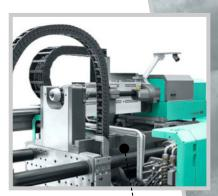
Posición M: segunda unidad de inyección en movimiento dispuesta sobre el plato de sujeción móvil.
