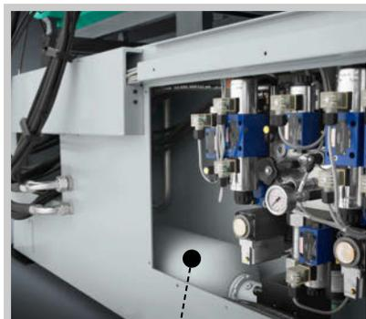
Hydraulikspeichertechnik: Beste Basis für große, dynamische Einspritzvolumenströme.
