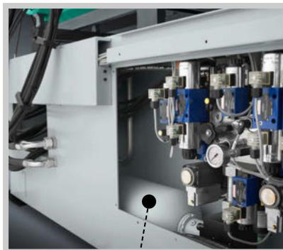
Tecnica ad accumulatore idraulico: la base ottimale per volumi di iniezione ampi e dinamici.
