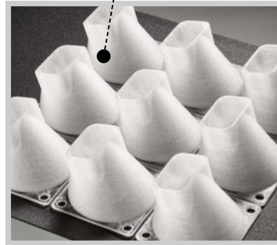
Einzelteil zur Automatisierung: Greifer mit produktspezifischer Soft-Touch-Oberfläche.
