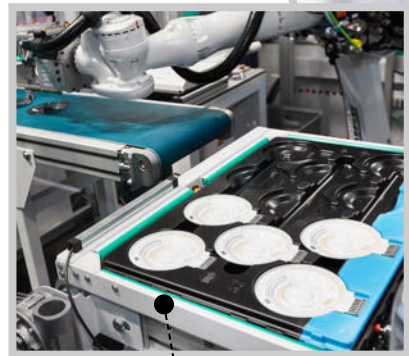
Film-Insert-Moulding: hohe Reproduziergenauigkeit durch servoelektrische Antriebe.
