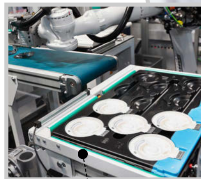
Film-Insert-Moulding: alta reprodutibilidade através de acionamentos servoelétricos.
