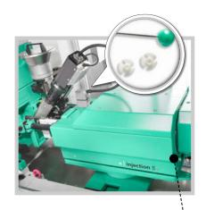
微型注塑: 使用尺寸为 5 的微型注射单元, 实现最小注射重量。
